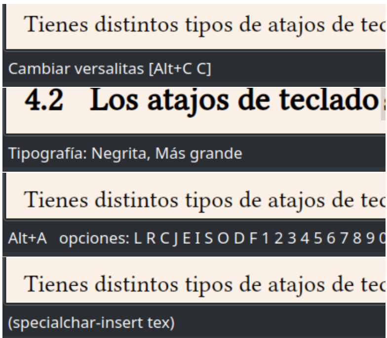
FIGURA 4.2: de arriba a abajo, la primera captura presenta la barra de estado mostrando la función de un botón de la barra de herramientas sobre el que se encuentra el puntero del ratón (si la acción tiene asociada un atajo de teclado, este se mostrará). La segunda captura presenta información del formato sobre el cual se encuentra el cursor. La tercera captura muestra cómo al activar la primera parte de algunos atajos de teclado LyX nos presenta todas las opciones disponibles. En la última captura se ve información relevante a una acción realizada a través de los menús y que no tiene (aún, ver la siguiente sección) un atajo de teclado asignado.
